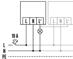
Installation standard avec raccordement en parallèle en option de 8 détecteurs de mouvement maximum.
