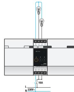
Ce module vous permet de commander trois circuits différents, par exemple des points d'éclairage, des prises de courant ou des vannes de régulation. Chaque contact peut aussi être commandé manuellement à l'aide d'un bouton. Le module permet de relier un neutre en vue d'un câblage ordonné dans le coffret électrique. Muni de trois LED de feed-back et d'une LED de statut, il consomme très peu d'énergie.
