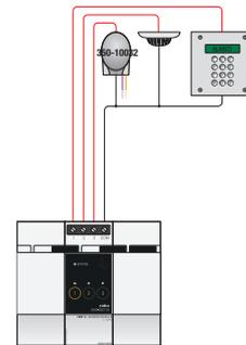
Ce module vous permet de connecter à l'installation Niko Home Control des capteurs possédant une sortie de contact numérique ou NPN et une très basse tension de sécurité (par exemple des interrupteurs crépusculaires, des détecteurs de fumée, des détecteurs de mouvement, des parlophones, des vidéophones).
