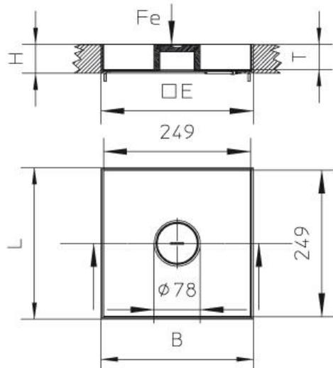
La cassette et le couvercle sont fabriqués en acier inoxydable. L'ouverture filetée centrale et le couvercle fileté sont fabriqués en aluminium anodisé.
