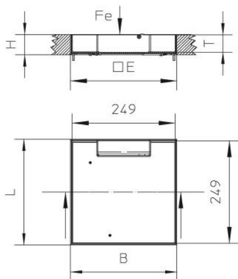
La cassette, le couvercle avec sortie latérale et le levier autofermant sont fabriqués en acier inoxydable.
