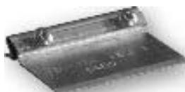
L'accouplement est fabriqué en aluminium. Pour coupler deux bases, l'accouplement est placé en bas et un autre en haut dans les creux prévus à cet effet. En serrant les vis M5x10 fournies, les raccords du canal mural sont fixés et parfaitement alignés.
