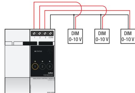
Le module de commande analogique 0-10 V vous permet de raccorder trois variateurs haute puissance à l'installation Niko Home Control. Trois variateurs dotés d'une entrée analogique 0-10 V peuvent être raccordés à ce module.
