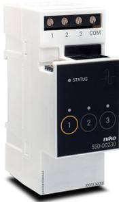
Le module de capteur analogique vous permet de raccorder trois capteurs analogiques externes à l'installation Niko Home Control. Utilisez toujours des capteurs adaptés aux applications à très basse tension de sécurité (TBTS). Il peut s'agir de capteurs pour la mesure de l'ensoleillement, du vent, de la pluie, du CO<sub>2</sub>, de l'humidité ambiante ou de la température. Vous pouvez ainsi commander d'autres stores, volets et sources d'éclairage, entre autres, en fonction des valeurs mesurées.
