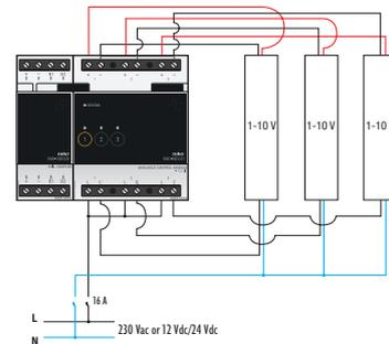
Le module de commande analogique 1-10 V vous permet de raccorder trois variateurs et/ou appareils de commutation à l'installation Niko Home Control :
