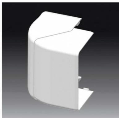
L'angle extérieur **K8406HB** s'encliquette sur les extrémités de la base, qui ne doivent pas être sciées en onglet. L'angle extérieur est réglable sur environ 8°. Il est ainsi possible de réaliser un bel angle extérieur en cas de parois non perpendiculaires.
