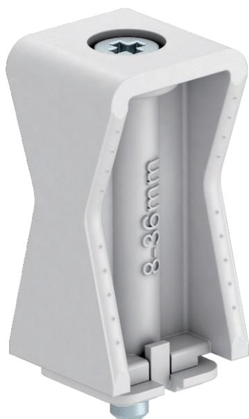
Convient également pour les rails avec une ouverture de 11 - 12 mm; Corps de pince en polystyrène antichoc sans halogène; gris clair RAL 7035; pièces métalliques en acier galvanisé.
