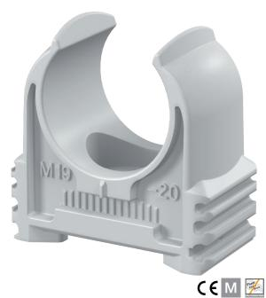
Collier OBO Quick de type 2957/...: pour les tubes métriques M16 et M19-20 ainsi que pour les tubes isolants métriques légers et lourds. Convient pour le raccord des tubes OBO Quick-Pipe. Les aides au centrage du tuyau permettent une insertion optimale du tuyau dans le collier. Possibilité de fixation universelle; peuvent être raccordés en série à l'aide des colliers OBO Multi-Quick et starQuick
