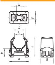
Dimension A 30,30 mm Dimension B 16,00 mm Dimension C 13,3 mm Dimension d 18,60 mm Dimension E 9,00 mm Dimension F 4,20 mm Dimension H 30,00 mm 7,00 mm Dimension h Juxtaposable  $\checkmark$ Nombre de câbles/tubes 1,00 Type de fixation Trou de vis Fermé Dimension nominale M19-20 Sans halogène  $\checkmark$ Avec garniture Plage de serrage D Résistant aux UV
