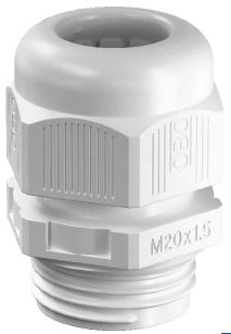
Le moyen le plus rapide et le plus pratique de fournir une décharge de traction et une étanchéité avec des presse-étoupes sur les boîtes de jonction et les boîtiers: les presse-étoupes V-TEC VM éprouvés d'OBO. Grâce au joint d'étanchéité intégré et à la technique spéciale de lamelles OBO, l'indice de protection IP68 est atteint. La décharge de traction et l'étanchéité sont contrôlées selon la norme DIN EN 62444
