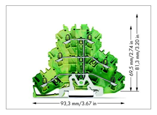
Aperçu d'impression: Borne à trois étages; Borne de protection pour 6 conducteurs; PE; sans support de marquage; Boîtier vert-jaune; avec pontage interne; pour applications Ex e II - Numéro d'article: 2002-3207
