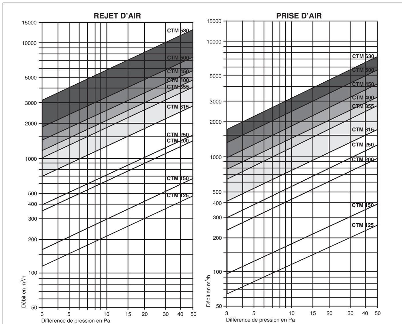
Le tableau ci-dessous indique les débits à 20 Pascals retenus comme limite d'utilisation conseillée des chapeaux de toiture, ainsi que les sections de passage d'air au niveau du conduit et au niveau des grilles.
