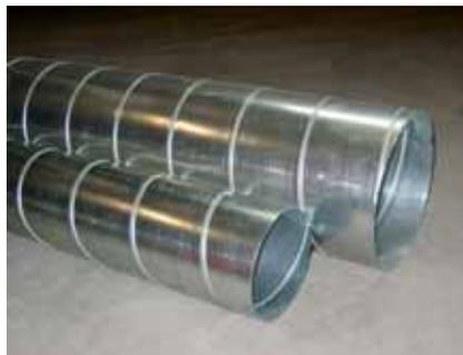
Les gaines de ventilation et les accessoires satisfont pleinement aux exigences mentionnées dans l'article C 14, caractéristique 105, édition 1990 de la Régie des Constructions. Les gaines sont construites au moyen de feuilles d'acier, suivant le respect des normes EN 10.142 et EN 10.143 avec une couche de zinc d'au moins 275g/m<sup>2</sup> (soit une couche de 20 µm d'épaisseur de chaque côté).
