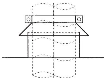
Passage de toiture avec solin en acier galvanisé livrable sur demande pour toiture inclinée
