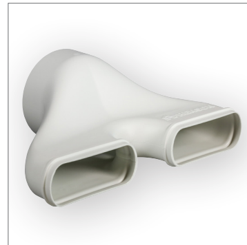
Réduction linéaire double 2 x 140 x 60 mm > Ø 125 mm - G0013141
