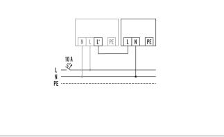
Raccordement standard avec interrupteur
