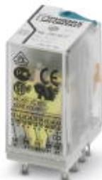
Relais industriels enfichables avec contacts de puissance, 4 contacts inverseurs, touche de test, LED d'état, affichage mécanique de position, tension de bobine : 24 V AC
