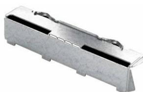
Les gaines à câbles sont raccordées moyennant des accouplements sans vis Unilock (référence 8010109). Placez les gaines à câbles à accoupler en position et insérez l'accouplement Unilock sous le bord du talon et conduisez-le jusqu'à ce qu'il est dans les 4 fentes de fond. Poussez l'accouplement passé son point de flexion.
