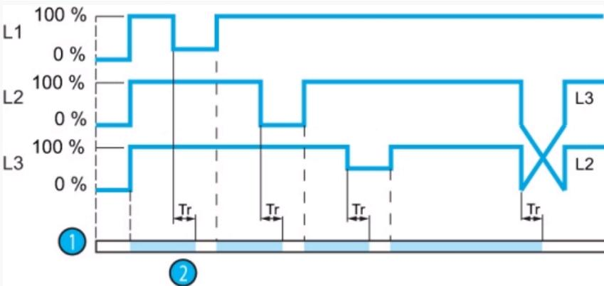
**Principe de fonctionnement****MWS-MWS2 : Contrôleur de phase**
