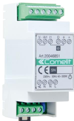
Module dimmer SimpleHome pour la régulation de lampes halogènes, compacts fluo (CFL), LED's dimmables et transformateurs électroniques. Puissance 300W. 1 entrée pour le raccord d'un bouton poussoir. Fonction dimmer avec un simple ou double bouton poussoir. Fonction pour le contrôle de présence pour l'économie d'énergie, qui va diminuer l'intensité lumineuse quand il n'y a pas de détection de mouvement. Dimensions : 35x90x58mm (2 DIN modules). Consommation max sur le bus : 25mA.
