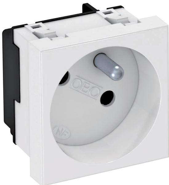
Prise de courant avec fiche de terre simple 33°, avec protection renforcée contre les contacts accidentels, avec bornes à fiche, 2 pôles, 16 A, 250 V<sup>~</sup>, avec bornes de raccordement selon CEI 60884-1.
