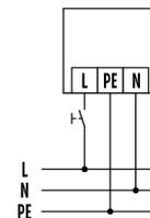
Raccordement standard avec interrupteur
