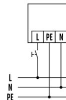
Raccordement standard avec interrupteur
