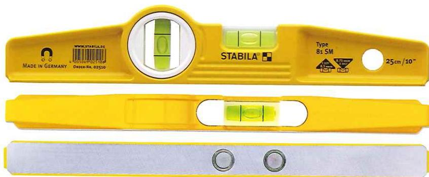
Corps en acier léger moulé sous pression avec semelle usinée, 1 fiole verticale et 1 fiole horizontale et 2, 8, 10 ou 12 aimants. **Précision de mesure** : en position normale  $0,029^\circ = 0,5 \text{ mm/m}$ , position inverse :  $0,043^\circ = 0,75 \text{ mm/m}$ .
