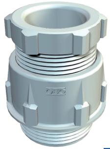
Presse-étoupe standard, forme A selon DIN 46320 bague d'étanchéité simple de NR/SBR. Raccord fileté selon DIN 40430.
