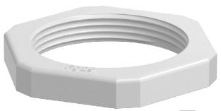
Contre-écrou selon la norme DIN 46320, avec filetage PG selon la norme DIN 40430. Conseil : contre-écrou en polystyrène, à serrer modérément en raison du risque de formation de fissures dues à la contrainte!
