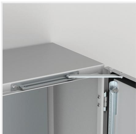
**Description:** Arrêt de porte. Convient à toutes les dimensions de coffrets muraux . Pour bloquer la porte en position ouverte. L'arrêt de porte peut être monté en haut ou en bas du coffret. L'usinage est nécessaire. Largeur minimum de l'armoire  $\geq$  300 mm.
