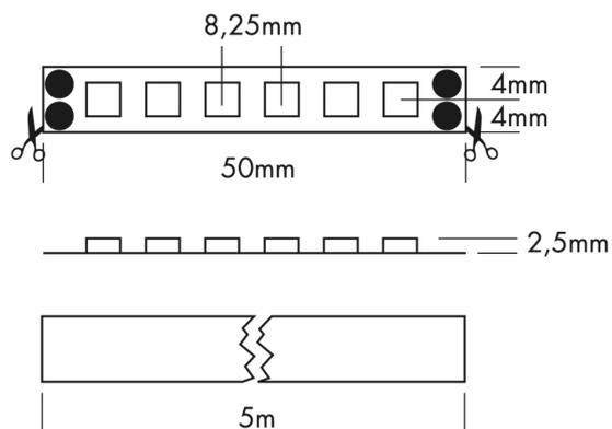
**40W 24Vdc IP20 CCT 4000K Im/m 960 IRC 90**
