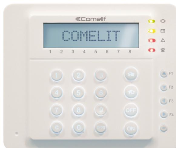
Clavier SAFEKEY avec afficheur LCD alphanumérique pour la gestion et la programmation des centrales d'alarme de la série VEDO. Équipé de 4 leds de signalisation (présence réseau, batterie faible, anomalie et alarme), 2 entrées à programmation libre comme entrées NF, NO, simple, double, triple équilibrage et double, 4 touches à fonction configurables, contact anti-arrachement . Blanc RAL9003.
