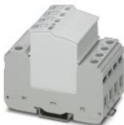
Parafoudre enfichable, suivant type 2 / Classe II, pour réseaux triphasés avec N et PE séparés (système à 5 fils : L1, L2, L3, N, PE), avec contact de signalisation à distance.
