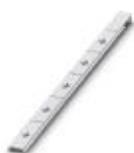
Repères pour blocs de jonction, Rubans, blanc, repéré, longitudinal: Symbole de mise à la terre, type de montage: encliquetage dans la rainure de repérage élevée, pour bloc de jonction au pas de : 18 mm, surface utile: 18 x 5 mm, Nombre d'étiquettes: 5
