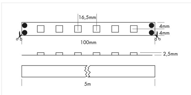
**4,8 lm/m**   **24 Vdc**   **IP 20**   **CCT 2700K**   **lm/m 420**   **IRC 90**
