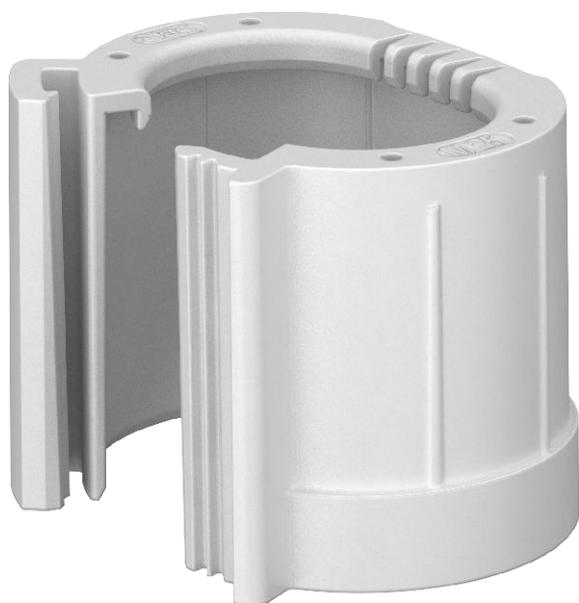
Douille terminale divisible à emboîter sur les tubes d'installation électrique métriques. La douille terminale de tube divisible peut être utilisée pour les installations réglementaires officielles et ultérieures. Étant donné qu'un débranchement des câbles n'est plus nécessaire, la durée du montage est réduite.
