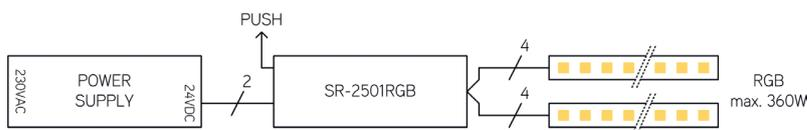
SR-2501RGB est une commande à bouton-poussoir pour bandeau LED RGB, et peut commander jusqu'à 360W en 24VDC. Le fonctionnement avec bouton-poussoir peut être facilement intégré dans votre appareillage existant.
