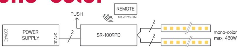
Le contrôleur universel SR-1009PD remplace le SR-2501 et possède désormais une commande bouton-poussoir pour bandeaux LED monochromes. Cela permet de combiner une commande RF avec une commande à bouton-poussoir.
