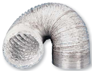
Classement: M0 Rayon de courbure mini: 0,6 \times \emptyset Température d'utilisation: -30^{\circ}\text{C} à +250^{\circ}\text{C}
