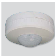
CPFL-S / CPFL-E Capteurs de présence. Mesure sensible aux rayonnements infra-rouge liés à la chaleur émise par le corps en mouvement. Angle de détection de 360°.
