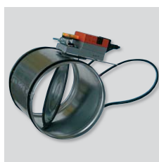
REMP Registre motorisé proportionnel. Registre motorisé circulaire avec corps en acier galvanisé et motorisation commandée par sonde de Co 2 . Adapté à la régulation et la modulation des débits. Commandé par signal proportionnel 0-10V. Associé au boîtier d'adaptation de signal "BEAS", permet d'ajuster les positions mini et maxi d'ouverture. s'utilise dans les systèmes de ventilation multi-zone type proportionnel.
