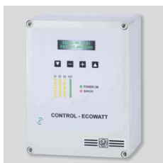
CONTROL ECOWATT AC/4A Elément de contrôle pour les systèmes de modulation des débits dans les installations de ventilation dans le tertiaire ou le résidentiel. Contrôle en continu de la vitesse des moteurs afin de s'adapter au besoin. Permet de réduire la consommation énergétique et maintenir une ambiance bien ventilée.
