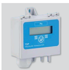
TDP-S / TDP-D Sondes de pression. Adaptées pour contrôler la pression dans les systèmes de ventilation en pression constante. Permettent la lecture de la différence de pression entre deux points de fonctionnement et de la transformer en signal électrique apte pour les différents appareils de contrôle.
