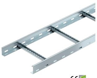
Échelle à câbles d'une hauteur latérale de 60 mm avec échelons soudés à profilé C30 ouvert vers le haut. Longeron latéral enroulé pour le renforcement et la protection des bords. La fixation sur console s'effectue avec des pièces de serrage de type LKS 40. La fente de l'échelon mesure 16,5 mm. La bride de fixation correspondante est de type 2056.
