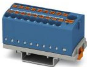
Bloc distributeur, Bloc avec orientation verticale et alimentation intégrée, Les blocs peuvent être pontés les uns avec les autres par l'orifice du conducteur. Ponts enfichables correspondants, voir Accessoires, tension nominale: 690 V, intensité nominale: 24 A, type de raccordement: Raccordement Push-in, Raccordement Push-in, nombre de connexions: 19, section : 0,14 mm<sup>2</sup> - 4 mm<sup>2</sup>, AWG: 26 - 12, largeur: 28,6 mm, coloris: bleu, type de montage: NS 35/7,5, NS 35/15
