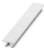
Repérage ZB, Rubans, blanc, vierge, repérable avec : PLOTMARK, CMS-P1-PLOTTER, type de montage: encliquetage dans la rainure de repérage élevée, pour bloc de jonction au pas de : 15,2 mm, surface utile: 10,5 x 15,1 mm, Nombre d'étiquettes: 5
