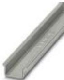
Profilé plein, Profil standard 2,3 mm, largeur: 35 mm, hauteur: 15 mm, selon EN 60715, matériau: Acier, galvanisé, traité par passivation couche épaisse, longueur: 2000 mm, coloris: argenté
