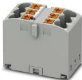
Bloc distributeur, Module de base, Les blocs peuvent être pontés les uns avec les autres par l'orifice du conducteur. Ponts enfichables correspondants, voir Accessoires, tension nominale: 450 V, intensité nominale: 24 A, type de raccordement: Raccordement Push-in, nombre de connexions: 6, section : 0,14 mm<sup>2</sup> - 4 mm<sup>2</sup>, AWG: 26 - 12, largeur: 16 mm, hauteur: 21,7 mm, coloris: gris, type de montage: encliquetage sur l'adaptateur de profilé
