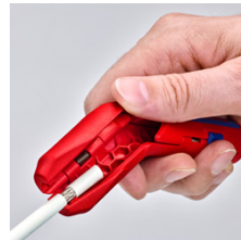
Dégainage d'un câble coaxial
