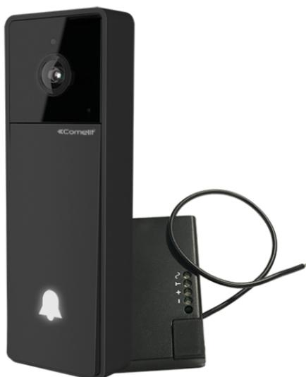
Sonnette smart conçue en Italie qui permet la communication audio/vidéo de la porte vers le smartphone/tablette en utilisant le réseau Wi-Fi. Complet avec adaptateur pour utiliser l'alimentation de la sonnette déjà existant (12÷20VAC ou 12÷33VDC) et pour interfacer la sonnette existant. Avec l'application Visto Vous serez toujours en contact avec ce qui se passe chez vous, si Vous êtes à travers la ville ou même dans un autre pays. Couleur dark graphite RAL9011.
