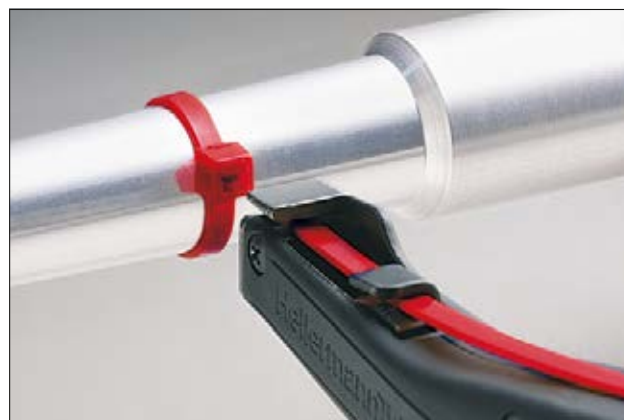
3: Coupe propre et nette du collier à ras, sans effort, ni heurt ou vibration ressenti par l'opérateur.
