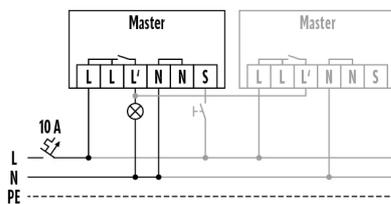
Raccordement maître/maître avec commande optionnelle par poussoir. Un appareil maître peut être raccordé à 8 appareils maître au maximum.
