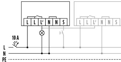
Installation standard avec commande en option par bouton-poussoir de fermeture et raccordement en parallèle de 8 appareils au maximum
