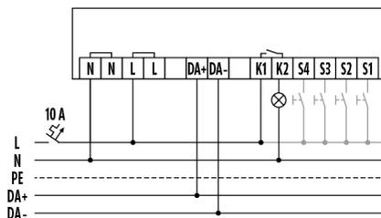
Raccordement avec commande optionnelle par poussoirs.
