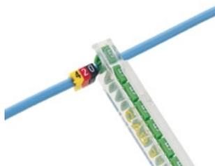
Chargeur transparent pour repères CAB 3 de section 0,5 à 1,5 mm<sup>2</sup> - rouge - assure la distribution et la mise en oeuvre rapide des repères sur le conducteur
