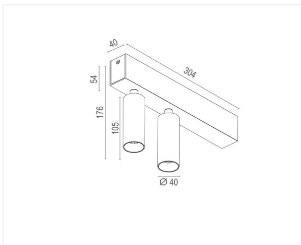
Luminaire apparent pour plafond ou mur en finition blanche ou noir mat moderne. Le module spot peut être tourné et incliné dans toutes les directions. Une solution idéale pour l'éclairage d'accentuation dans les espaces résidentiels ou commerciaux.
