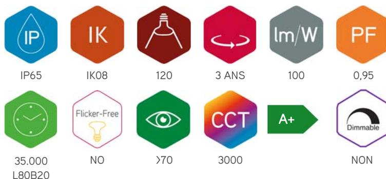
QT Floodlight blanc chaud 3000K 20W dans un boîtier noir en aluminium avec protection Interpon pour des environnements corrosifs. Equipé avec une verre de sécurité transparent et un réflecteur de 120°. Livré avec un presse étoupe M16 et un boîtier de raccordement intégré pour le raccordement de câbles jusqu'à 3G1,5 mm<sup>2</sup>.
